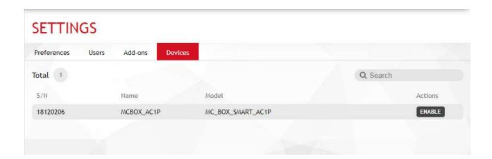
In diesem Abschnitt (nur für Benutzer mit Administratorrechten sichtbar) sieht man die Liste der aus der Anlage gelöschten Vorrichtungen. Wenn eine Vorrichtung versehentlich gelöscht wurde, kann sie durch Betätigung der Taste wieder aktiviert werden.
