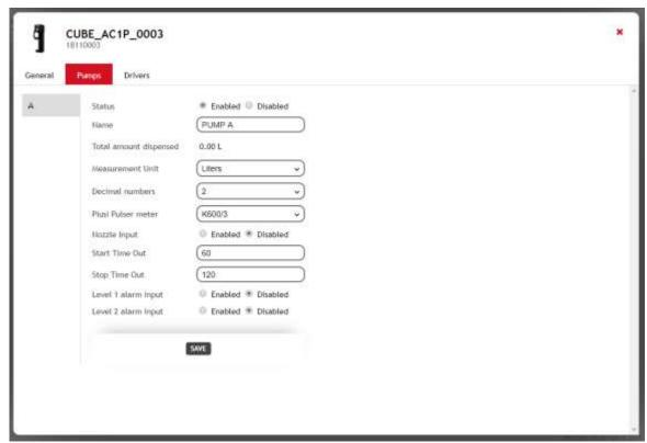
Auf diesem Bildschirm kann die Konfiguration der mit dem Gerät verbundenen Förderpumpen geändert werden, insbesondere:
