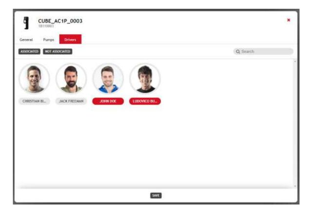
Auf diesem Bildschirm können die der Zapfsäule zuzuordnenden Fahrer eingegeben werden. Nur zugeordnete Fahrer können sich für den Tankvorgang an der Zapfsäule authentifizieren (über die Smartphone-Anwendung oder den Ibutton) Ein einzelner Fahrer kann mehreren Zapfsäulen der Anlage zugeordnet werden.
