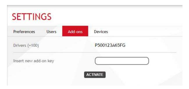
Auf diesem Bildschirm kann die Liste der aktiven Erweiterungen für die eigene Anlage angezeigt oder neue können aktiviert werden. Nach dem Kauf einer neuen Erweiterung, diese durch Eingabe des Codes und Betätigung der Taste
