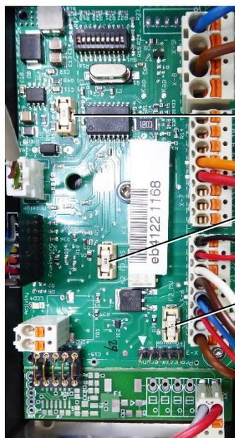
Sicherung 2 A für 24-V-Stromversorgung Platine
