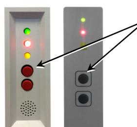
Taste „Ton aus“ drücken und gedrückt halten, bis der Leuchtmelder „Alarm“ schnell blinkt, dann loslassen. Ein Wert für die Dichtheit wird wie folgt angezeigt:
