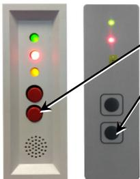
Taste „Quittierung Trockenfiltermeldung“ kurz drücken, dadurch wird das akustische Signal abgestellt. Die optische Anzeige (wechselseitiges Blinken der roten und gelben LED bleibt bestehen).
