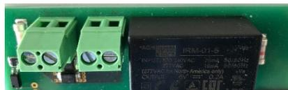
S+/S- Verbindung zum Sondenkontakt der Hauptplatine
