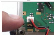
3 - Sostituire la scheda, facendo attenzione che il cavo di alimentazione sia correttamente connesso alla nuova scheda
