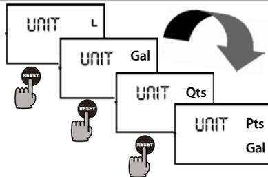
**4** Mettre en mémoire la nouvelle combinaison en appuyant longuement sur la touche cal. Volucompteur Numerique A Turbine K24 passera par le cycle de mise en marche et sera prêt à distribuer dans les unités préétablies
