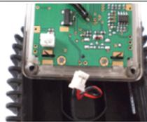
2 - Das Versorgungskabel von der Platine lösen und die Platine entfernen.
