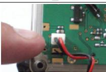
3 - Die Platine ersetzen und dabei darauf achten, dass das Versorgungskabel richtig mit der neuen Platine verbunden wird.
