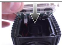
4 - Die neue Platine und die Stirnblende wieder am Literzähler anbringen und dabei auf den korrekten Verlauf des Kabels achten.
