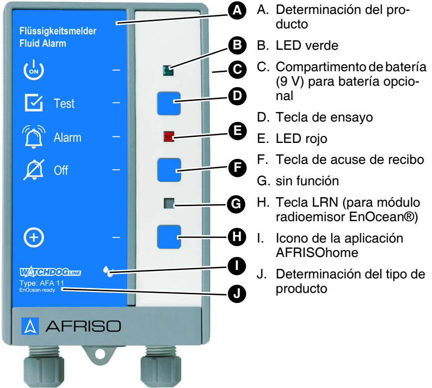
Figura 2: Unidad de control
