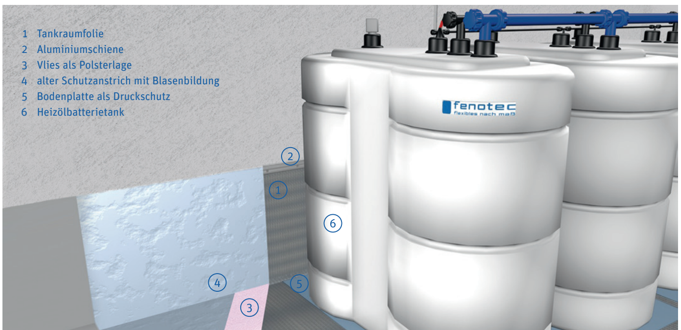
Tankraumauskleidung für einen Batterietank
