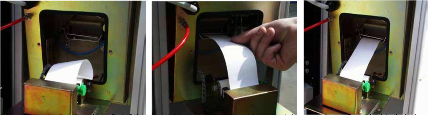
7) Das Papier in den Druckkopf einführen und hierbei auf die korrekte Ausrichtung achten. Den Blockierhebel; mit der entsprechenden Rändelschraube wieder schließen und eine ausreichende Menge Papier aus der Schneidevorrichtung auf der Vorderseite von FM BOX ziehen.
