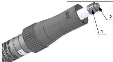
1 - 2 capteurs de fin de ravitaillement : ils sont utilisés pour mettre fin au ravitaillement
