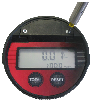
Bild 1: Lösen des Batterie- deckels
