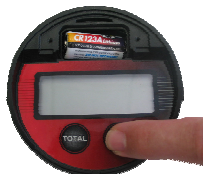
Figura 3: Coloque la nueva batería y presione el botón "RESET" para verificar la operación del registro
