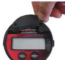
Figura 4: Coloque la tapa de la batería y atornille
