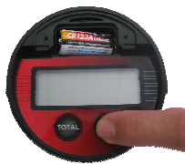
Illustration 3: Insérer la nouvelle pile et appuyer sur RESET pour vérifier les fonctions
