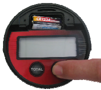
Bild 3: Neue Batterie einsetzen, danach die Reset-taste drük- ken, um die Funktion des Zählwerks zu prüfen
