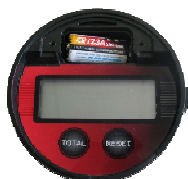
Bild 2: Herausnehmen der Batterie
