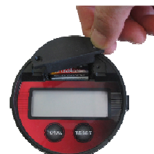
Bild 4: Einsetzen des Batteriedeckels, danach Batteriedeckel festschrauben
