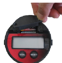
Illustration 4: Revisser le couvercle de la pile
