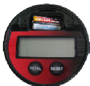
Illustration 2: Retirer la pile de son compartiment
