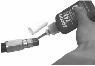
1. Teil an Messgerät befestigen. Gewindeabdichtungsmittel am äusseren Schlauchende anbringen. Empfohlenes Abdichtungsmittel: Loctite® 243.
