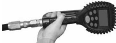
2. Metallenes Schlauchende in Teil stecken. Mit einem Gabelschlüssel fest anziehen.
