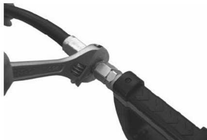
**Beachte:** Der Teil des Messgerätes mit Gewinde besitzt zwei Innengewinde. Das metallene Ende des Schlauches muss Aussengewinde haben. Gewindeabdichtungsmittel, Loctite® 243 oder ähnliches am äusseren Ende anbringen. Ein- und Ausgang der Teileanschlüsse sind entweder 1/2" NPT oder 1/2" BSPP, je nach Messgerätemodell.
