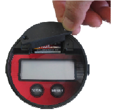
Bild 4: Einsetzen des Batterie- deckels, danach Batterie- deckel festschrauben.
