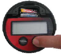
Bild 3: Neue Batterie einsetzen, danach die Reset-taste drück- en, um die Funktion des Zählwerks zu prüfen
