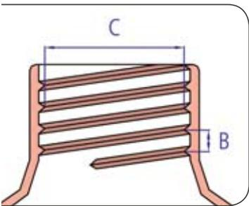
Bei Kunststofffässern und Behältern gibt es die verschiedensten Gewindearten. Ein Teil ist genormt, nach DIN-, BSI- oder US-Norm. Außerdem gibt es herstellerspezifische Gewinde. Für die meisten Behältergewinde liefern wir passende Adapter, damit Ablasshähne, Pumpen und anderes Zubehör sicher montiert werden können. Damit der richtige Adapter bestellt werden kann, gehen Sie folgendermaßen vor:
